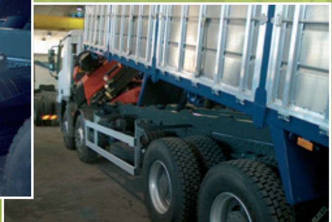
Protecciones laterales según normativa, abatibles y desmontables.
