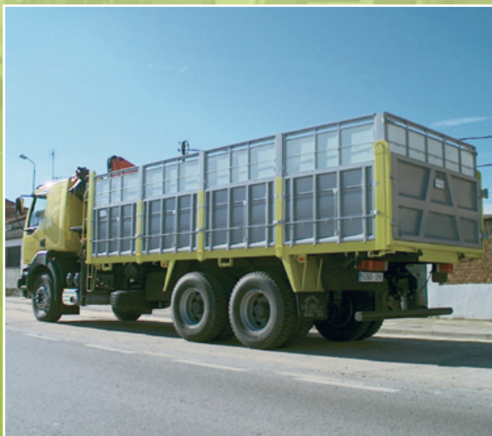
Carrocería comercial basculante con laterales en chapa plegada y suplementos en polyester.
