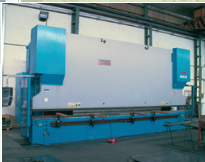
Plegadora Automática por control CNC de 500 TN. x 7 metros.
