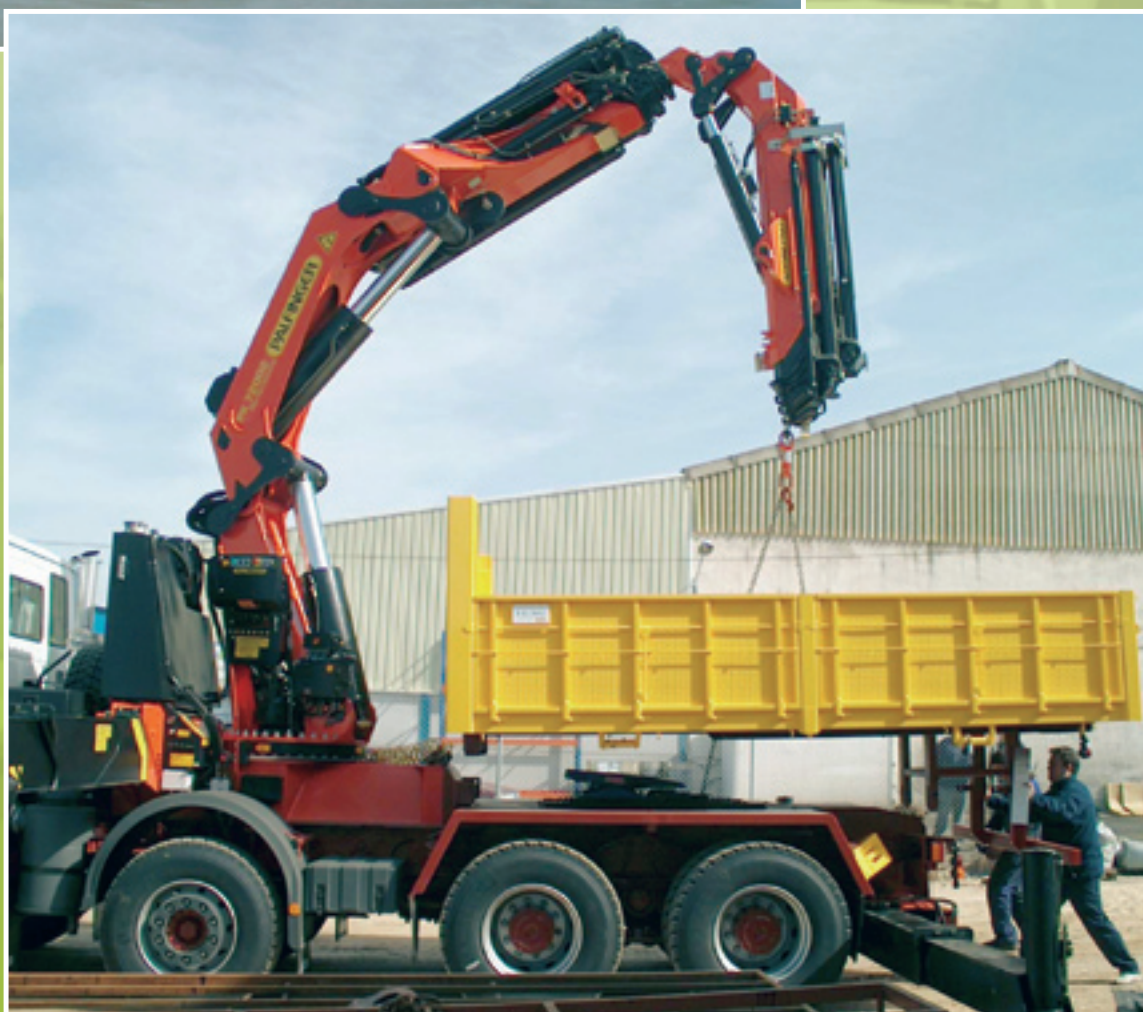
Grúa PK 72002 con cabestrante y JIB montada sobre tractora 4 ejes y carrocería desmontable.
