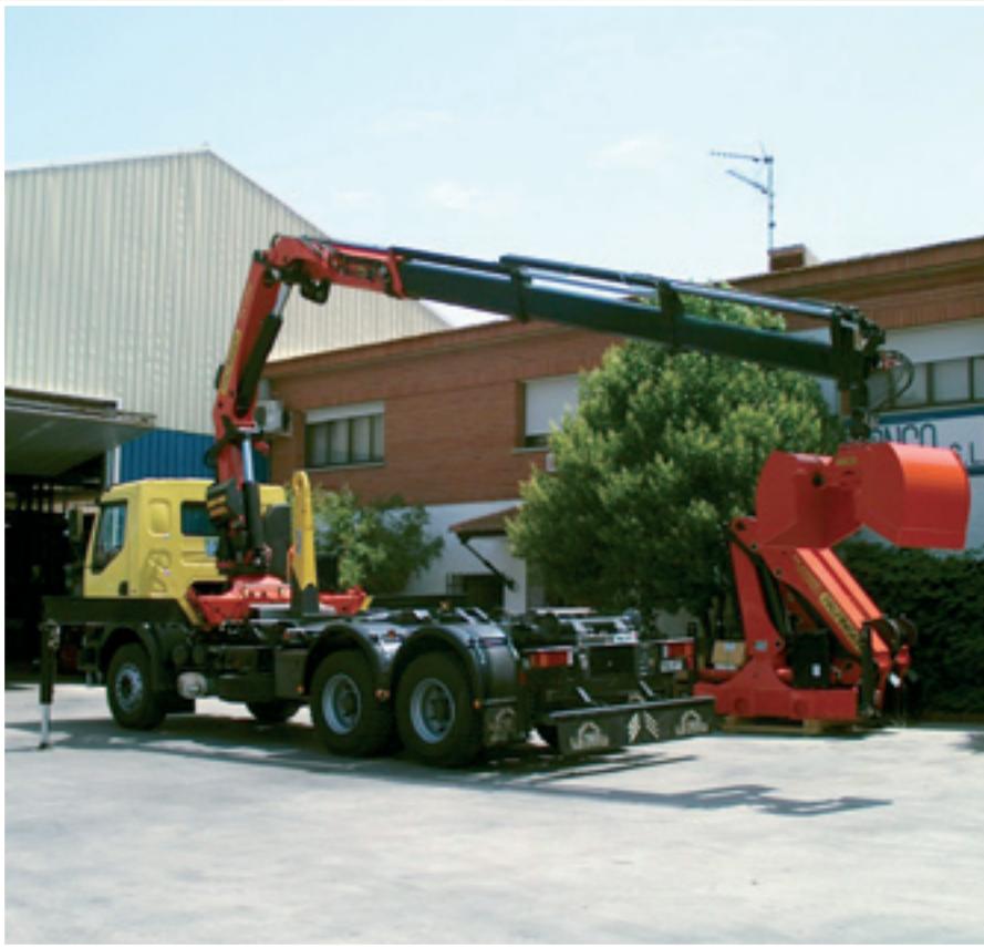
Equipo polibrazo Palift 26 TN. con grúa PK 21000 con acoplamiento para vivalda.
