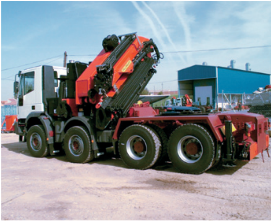
Grúa PK 72002 con cabestrante y JIB montada sobre cabeza tractora 4 ejes con estabilizadores traseros.
