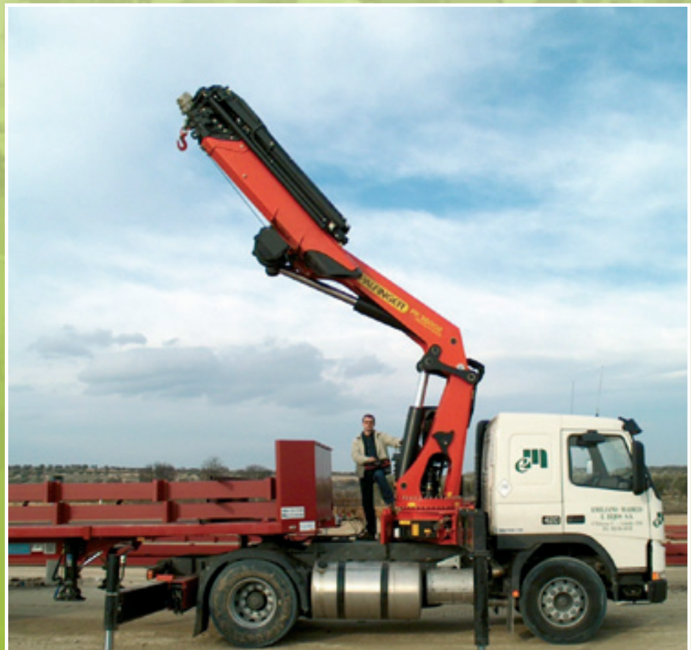
Grúa PK 72002 con cabestrante y JIB montada sobre cabeza tractora 4 ejes con estabilizadores traseros.
