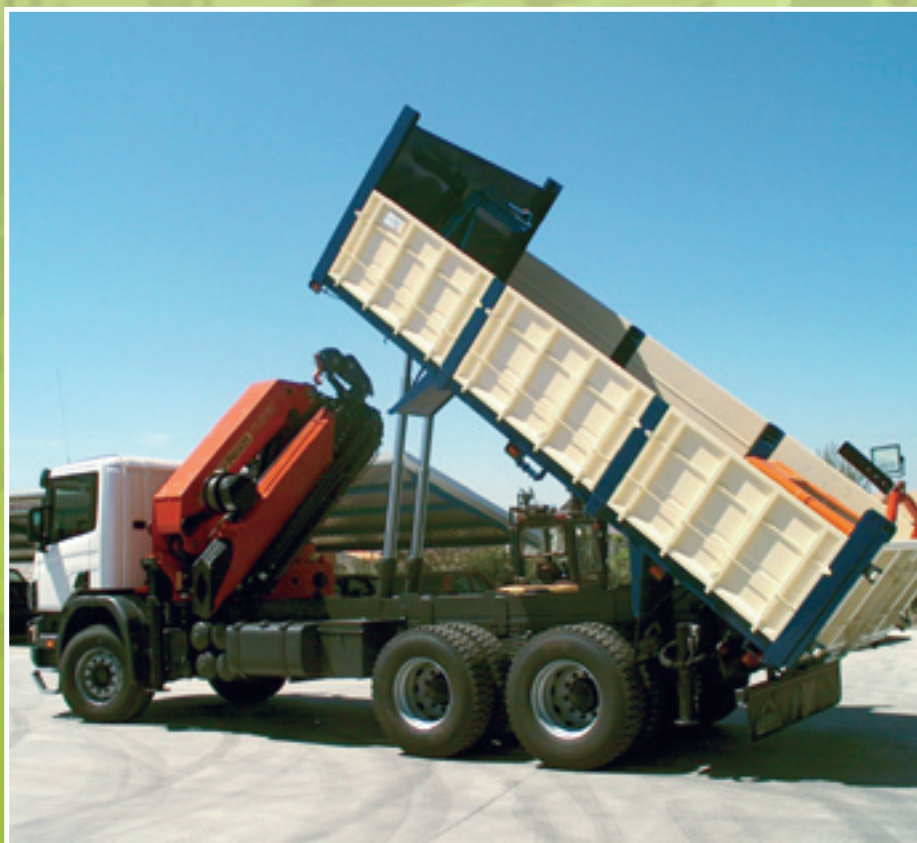
Carrocería comercial basculante con laterales en chapa plegada y grúa PK 36002 con cabestrante y acoplamiento para cesta de trabajo.
