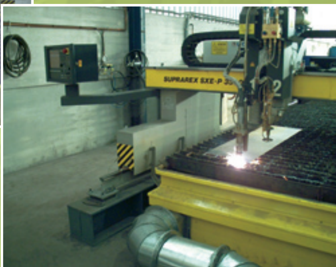
Estación de corte por plasma de alta definición de 200A, control numérico avanzado, soplete oxigas y filtro para gases contaminantes.
