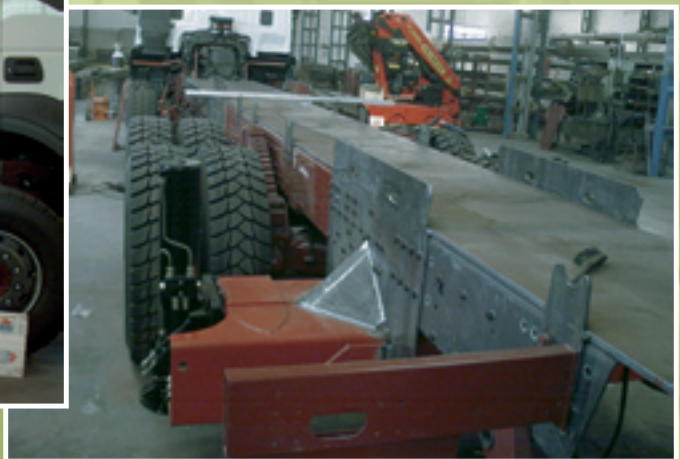
Refuerzos para montaje de PK100002 y estabilizadores traseros.
