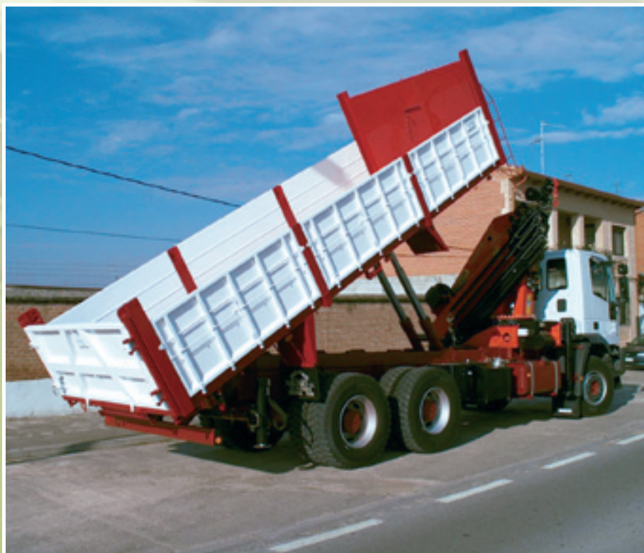
Carrocería comercial basculante con laterales en chapa plegada y grúa PK 29002 con cabestrante.
